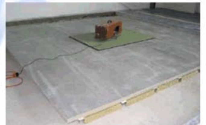
测试操作：CDM-ISO-LAT-79050 加两层18毫米厚的层面
