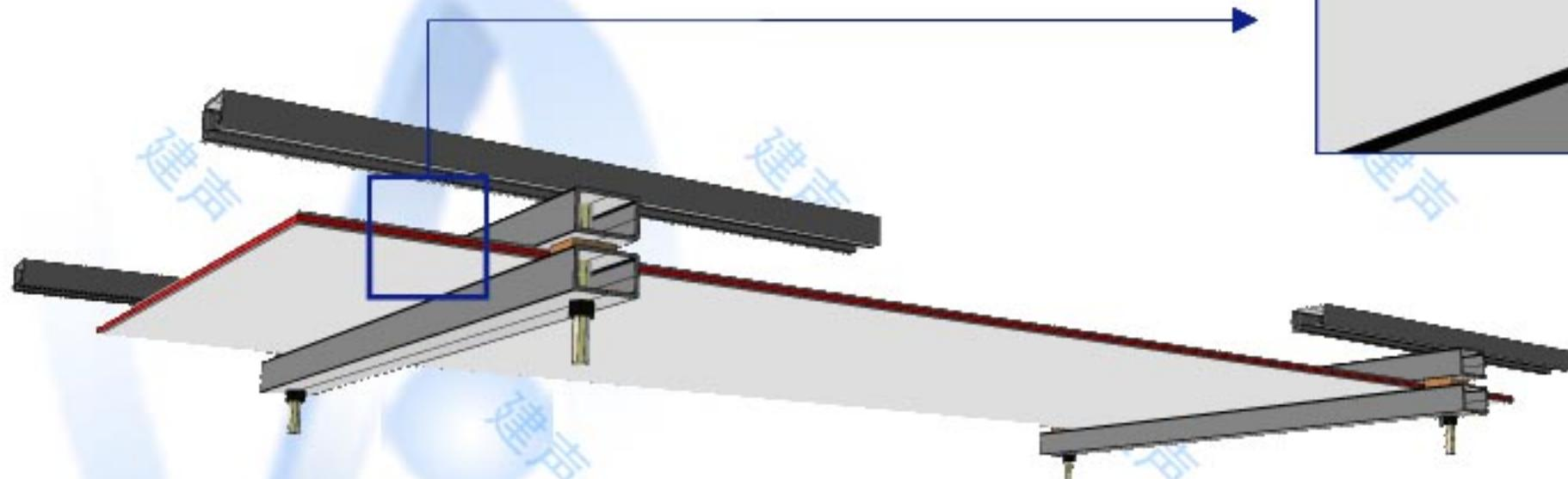
該系統是基於可調的限制層面減振夾合板上的可調點式連接減振裝置，附在振動地板或結構的下方。此系統可裝入深度不及200毫米的地方，也即是說可裝入懸浮天花板。
