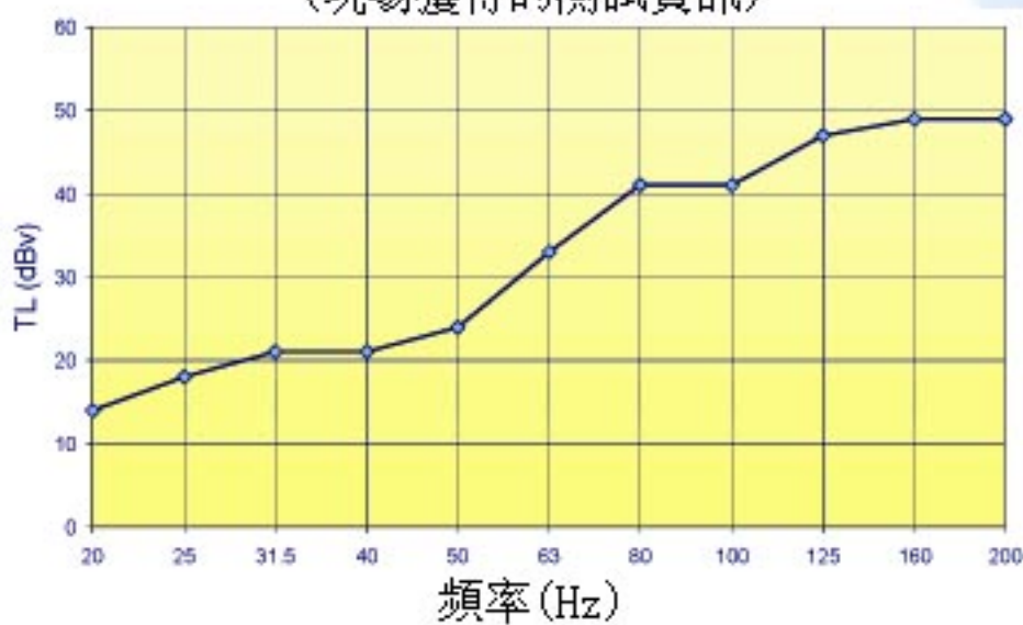
輸送損 TL = -20 \log(A/B) (現場獲得的測試資訊)
